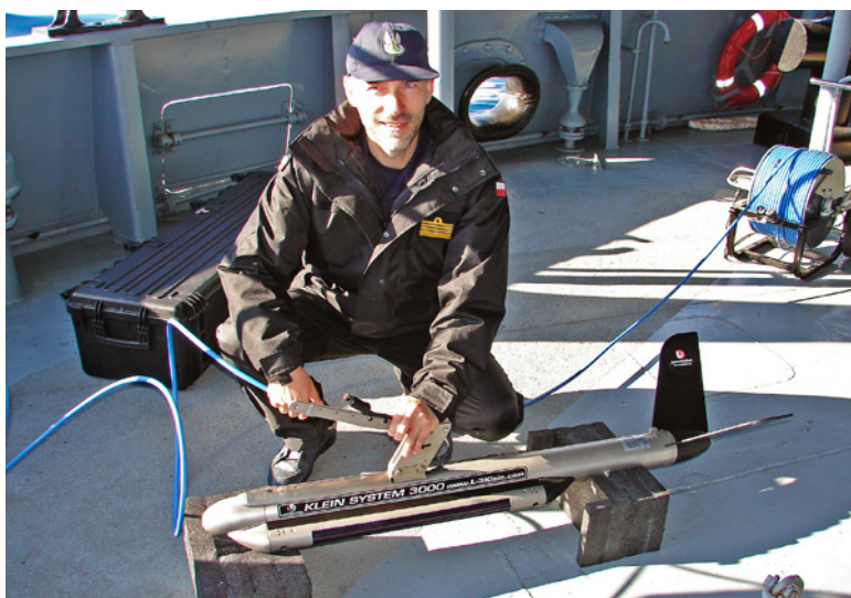
8. Sonar L3 Klein 3000. Źródło: archiwum prywatne D. Grabca
