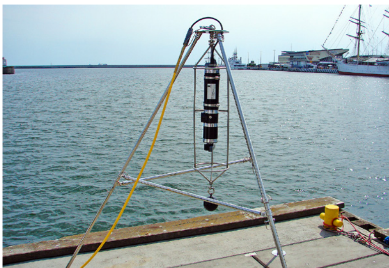
9. Zestaw sonaru MS 1000 firmy Kongsberg Mesotech 675 kHz. Źródło: archiwum prywatne D. Grabca
