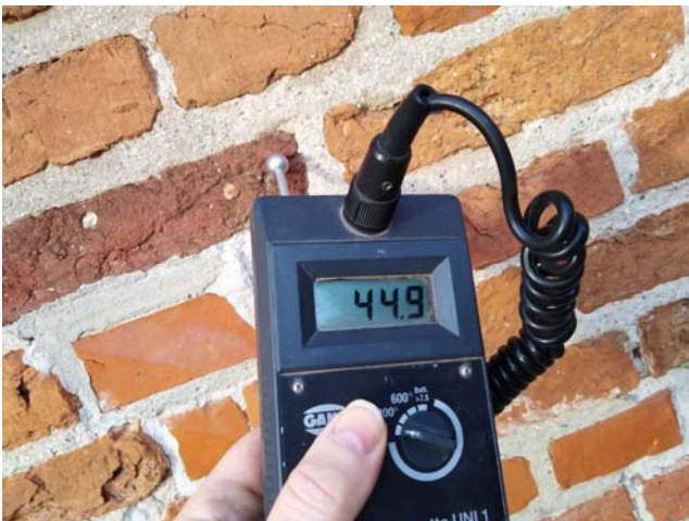
Fot. 4. Różnice we wskazaniach przyrządu GANN. Na cegle po lewej stronie wskazania w zakresie suchym
