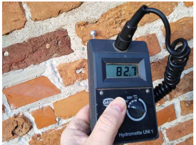
Fot. 5. Różnice we wskazaniach przyrządu GANN. Na cegle po prawej stronie wskazania w zakresie wilgotnym
