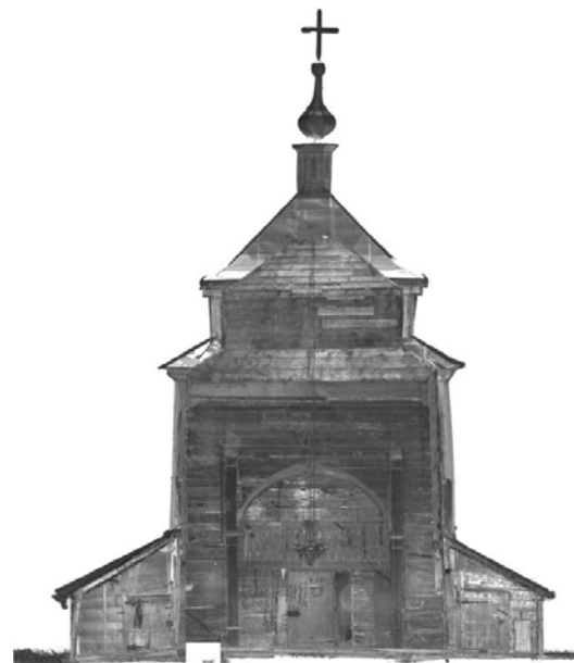
86,87. Leżachów, pow. przeworski. Cerkiew św. Nikity, przekrój poprzeczny z widokiem na pn.-zach. ścianę nawy. Po lewej: rysunek projektowy na podstawie inwentaryzacji. Rysunek jest dalece rozbieżny z rzeczywistymi wymiarami i architekturą zabytku. Wysokość cerkwi na nim wynosi 11,75 m; wysokość obiektu pobrana z chmury punktów wynosi 16,03 m. Rozbieżność wysokości rzeczywistej i tej zawartej w projekcie wynosi aż 4,28 m. Wśród elementów projektowanych uwagę zwracają ahistoryczne soboty, betonowe schody i kamienne podmurówki. J. Jarosz, B. Buliński, Projekt architektoniczno-budowlany prac remontowo-konserwatorskich przy dawnej cerkwi greckokatolickiej p.w. św. Nikity, a obecnie rzymskokatolickiego kościoła filialnego p.w. „św. Mikołaja” w Leżachowie, gmina Sieniawa, Jarosław 2015, s. bp., rys. 8. Po prawej: przykład obiektywnej dokumentacji wygenerowanej z chmury punktów. Zbiory autora.
