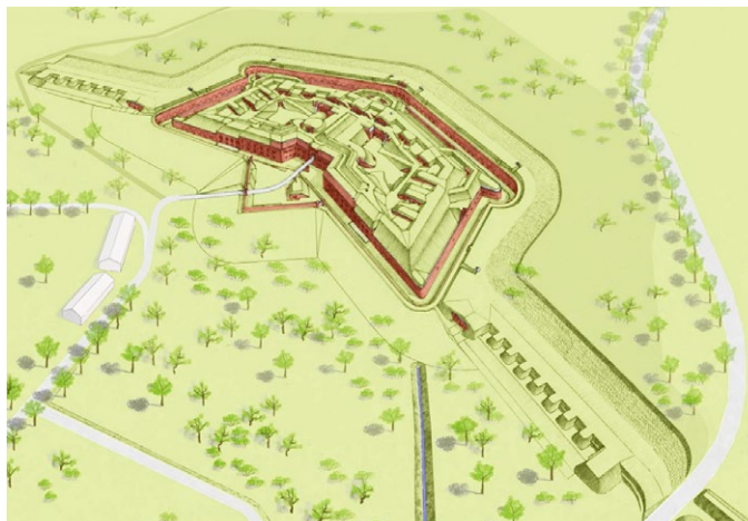
11. Fort standardowy, artyleryjski, nr IV (1878-1884) Twierdzy Toruń, element systemu obronnego fortowego w odmianie ześrodkowanej, koncepcja Alexisa von Biehlera. Rys. M. Wichrowski
