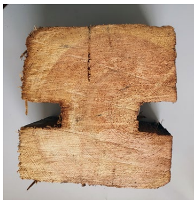
Il. 16 Toruń, oficyna na ul. Mostowej 14. Plaster z belki stropowej pobrany do badań dendrochronologicznych (fot. M. Prarat, 2022)
