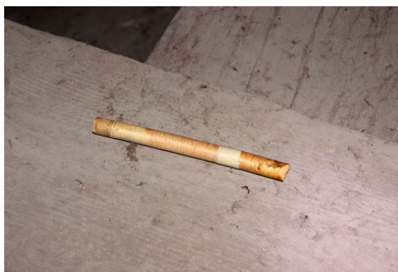
Il. 15 Toruń, kościół pw. św. Janów. Nawa główna. Próbkę do badań dendrochronologicznych (fot. M. Prarat, 2019)
