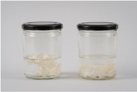
Pęcherze rybnie w wodzie. Po lewej świeżo zalany wodą pęcherz. Po prawej po 24 h w wodzie. Na zdjęciu widać zmiany, jakie zachodzą pod wpływem długotrwałego oddziaływania wody na pęcherz rybi
