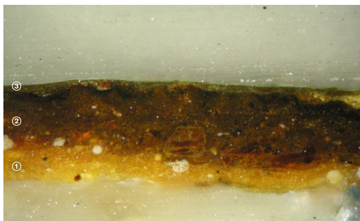
il 1 Próbka warstwy malarskiej pobranej z obrazu sztalugowego, widziana w przekroju poprzecznym w świetle białym (u góry) i ultrafioletowym (u dołu): ① warstwa gruntu malarskiego; ② warstwa malarska; ③ cienka warstwa werniksu, szczególnie wyraźnie widoczna w świetle ultrafioletowym
