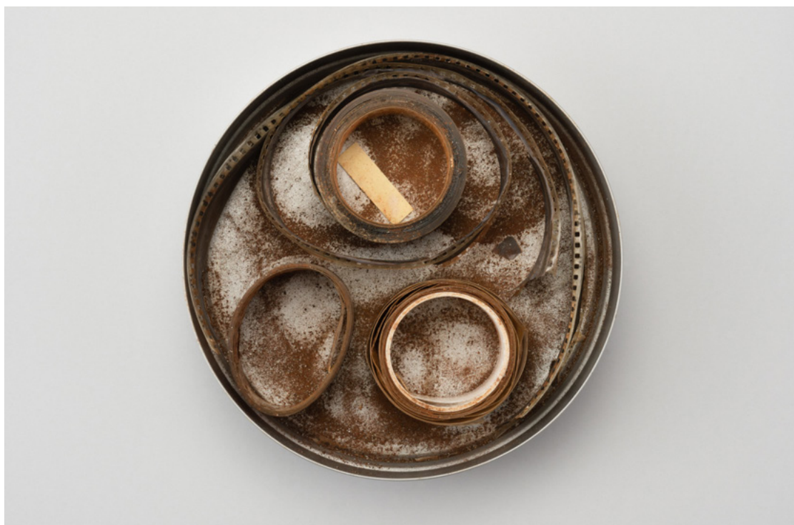
il. 8 Degradacja negatywów fotograficznych spowodowana autokatalityczną reakcją rozkładu tworzywa sztucznego
