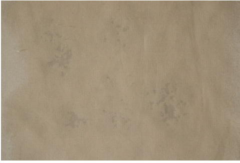
il. 6 Tkanina poliestrowa po zwilżeniu – brak deformacji wynikających z absorpcji wody
