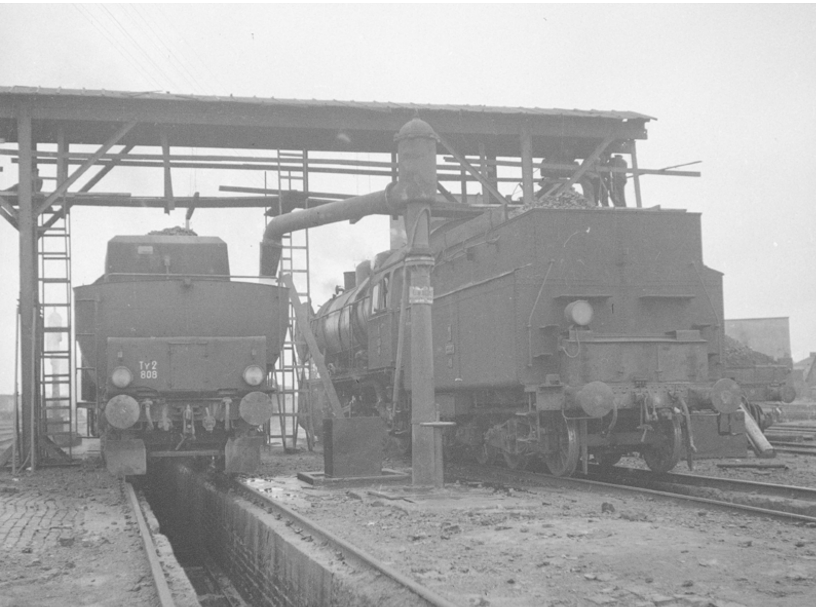
Parowóz serii Ty 2 nr 808 (z lewej) podczas uzupełniania wody za pomocą żurawia wodnego. Z prawej parowóz serii Ty 23. Warsztaty Główne i parowozownia Warszawa-Praga, 1958 r. Fot. Zbyszko Siemaszko/NAC
