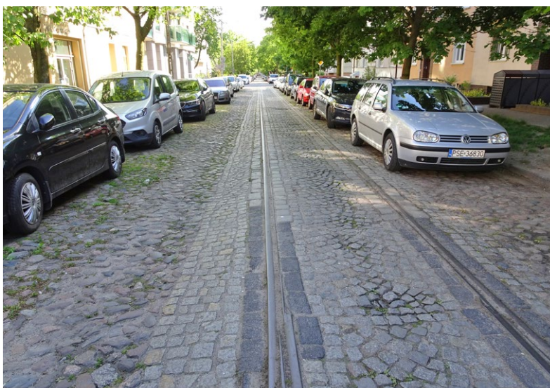
73 Poznań, ulica Bogusławskiego. Parkujące pojazdy w znacznym stopniu zasłaniają widok na ciekawy układ nawierzchni wraz z torami tramwajowymi. Dodatkowo obecność pojazdów powoduje, że rzadziej używane części jezdni przerastają trawą. Fot. Andrzej Billert
