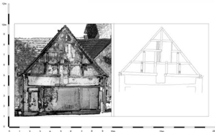
Abb. 3: Ansicht der Punktwolke in 3dworks mit erstelltem Querschnitt durch Erd- und Dachgeschoss des Wohnhauses, Blick auf Nordseite des Giebels des ursprünglichen Fachwerkhouses. Die Zeichnung des Abbundes des Giebels mit Schwalbenschwanzverblattungen wurde aus der Punktwolke automatisch generiert und digital manuell nachbearbeitet. Bildrechte: Amir Besirovic.
