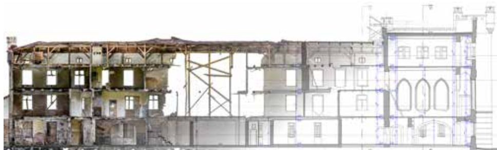
Fotogrametria jako podstawa do wykonania dokumentacji architektonicznej dla pałacu w Koziej Górze – przekrój
