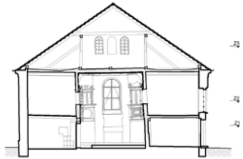
Il.1. Kościół pw. Matki Bożej Różańcowej w Bykowie, przekrój poprzeczny, oprac.: M. Kumorowicz-Brzeska, D. Jagiełło (szrafurą oznaczona przestrzeń niedostępna)
