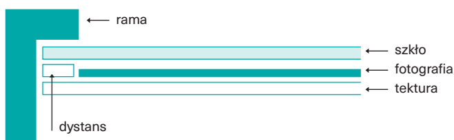
il. 12 Schemat oprawienia fotografii w ramę „z dystansem”
