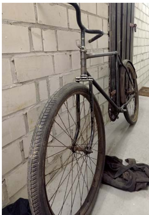
Rama roweru Łucznicz typ 17 przed rozpoczęciem czyszczenia powierzchniowego wełną stalową
