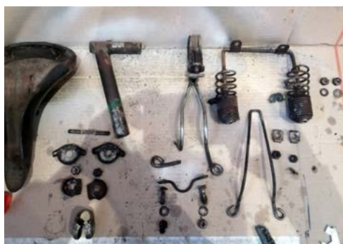
To samo siodełko po demontażu na części, jeszcze przed renowacją. Uwagę zwraca pęknięcie wzdłużnego elementu stelażu. Kolekcja autora
