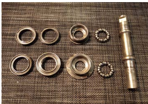
Ten sam zestaw, uzupełniony o oś suportu, po czyszczeniu i myciu
