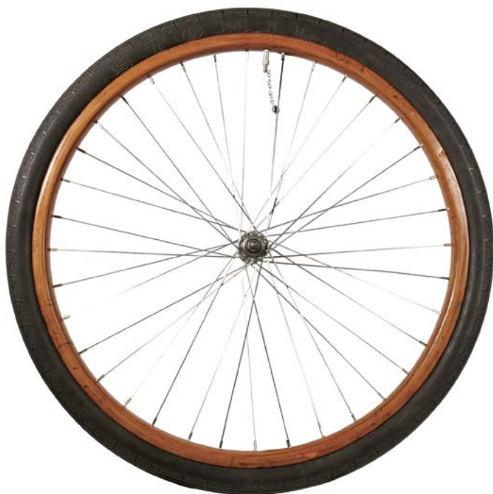
Koło na drewnianej obręczy 26" firmy Labor. Na obręczy opona drutowa Stomil z lat 50. xx w. Rozmiar opony to 571, 26×1 3/4"
