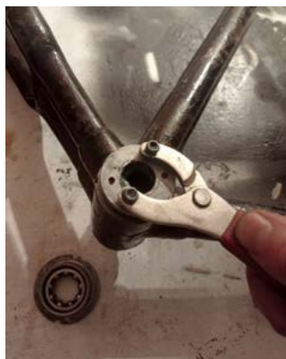
Support systemu BSA z miseczkami o lewym i prawym gwincie. Miska lewa (ma też nakrętkę kontrolującą) wkręcana jest w prawo, a odkręcana w lewo. Miska prawa (tzw. stała) wkręca się w lewo, a odkręca w prawo! Na zdjęciu widoczne wkręcanie miski prawej za pomocą specjalnego klucza
