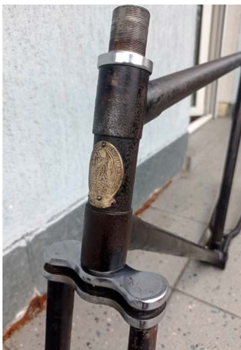
Rama roweru Łucznicz typ 17 z 1938 r. po oczyszczeniu chromów wełną stalową. Ramę stalową poddano czyszczeniu wełną 000, a następnie w miejscach korozji zastosowano punktowo inhibitor rdzy. Całość potraktowano woskiem
