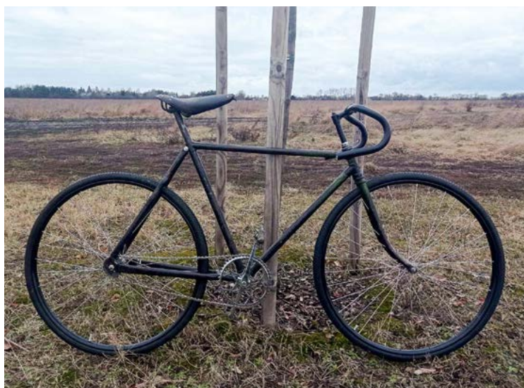
Rower turystyczny „Syrena” z wytwórni Bronisława Wahrena w Warszawie, ok. 1925 r. Uwagę zwraca mała główka ramy, cofnięty środek ciężkości oraz wczesne, prymitywne tylne haki połączone z bardzo grubymi tylnymi widełkami. Rama roweru ma zintegrowane stery, suport wkręcany typu BSA oraz wąskie przednie widełki z otworami na oś przedniej piasty. Kolekcja autora
