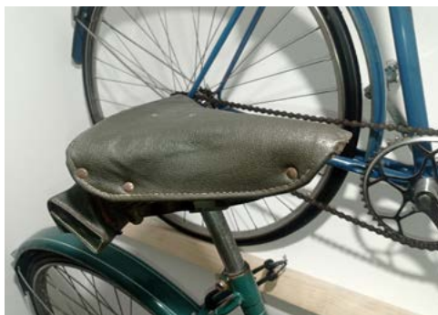
Polskie siodełko z tworzywa sztucznego będące na wyposażeniu roweru Mesko Nimfa, druga połowa lat 50. xx w. Kolekcja Michała Mańkowskiego
