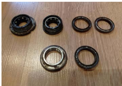
Brudny zestaw misek suportu z wiankami łożyskowymi oraz elementami sterów
