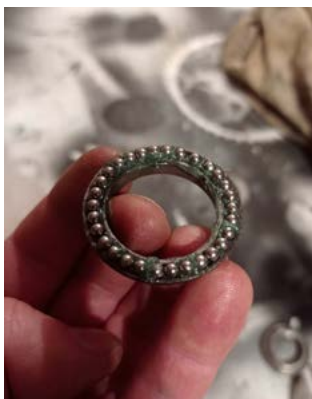
Dolna bieżnia sterów osadzona na dole rury widelca z osadzonymi kulkami łożyskowymi
