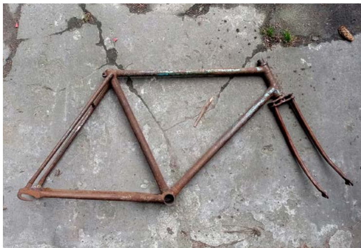
Typowa polska męska rama balonowa z lat 30. xx w., w tym przypadku z wytwórni Adama Kamińskiego z Warszawy. Widoczne duże ubytki lakieru oraz brak suportu i sterów widelca. Kolekcja Mirosława Krawczyka
