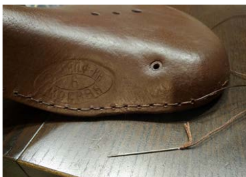
Szycie powłoki skórzanej siodełka z roweru produkcji ZSRR
