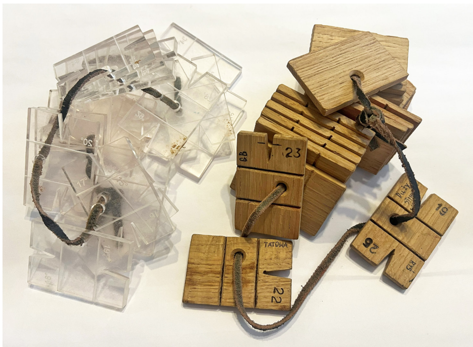
Il. 12. Wzorniki zapewniające powtarzalność ostrzenia, fot. C. Romanowski
