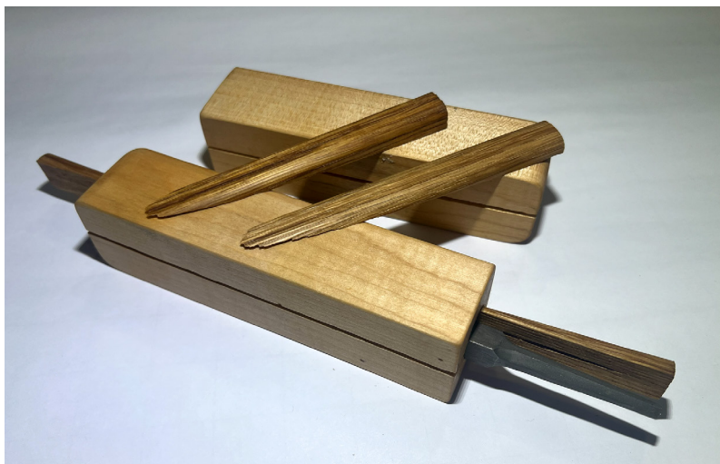
Il. 10. Przyrząd do wyrównywania zębów w ręcznych piłach, fot. C. Romanowski
