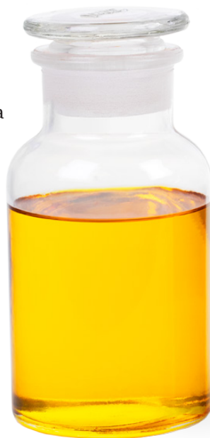
Surowy olej lniany po oczyszczeniu. Ta wersja oleju nie była poddana dodatkowemu wybielaniu
