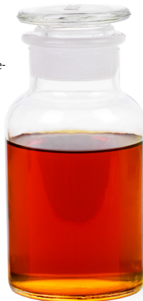
Olej lniany gotowany, czyli po procesie kontrolowanej oksydacji przez podgrzewanie, bez dodatkowego wybielania
